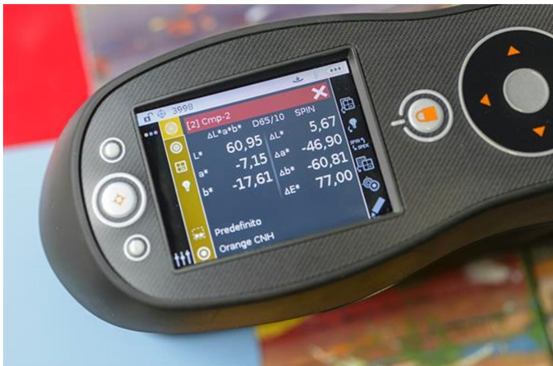
X-Rite Ci64 – отличный выбор для проведения измерений на 2-х и 3-х мерных объектах, включая металлизированные поверхности.
