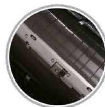
Зажим передней кромки пластины
