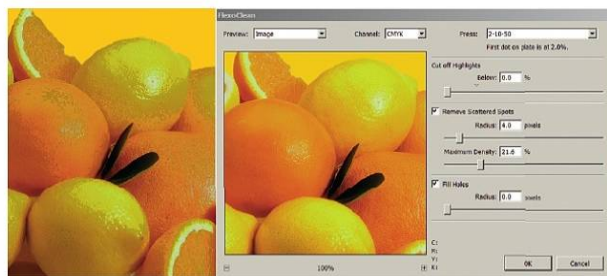
Финальная коррекция изображения для флексопечати при помощи FlexoClean
